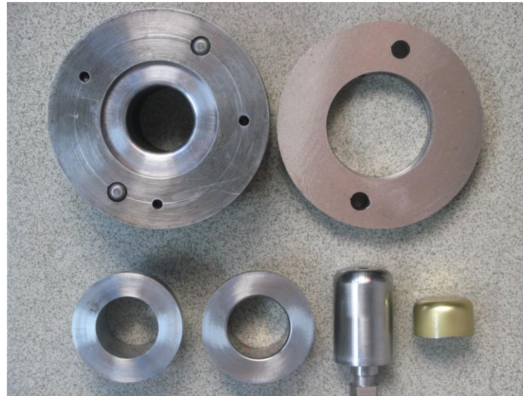
拉伸冲杯试验模具与产品
